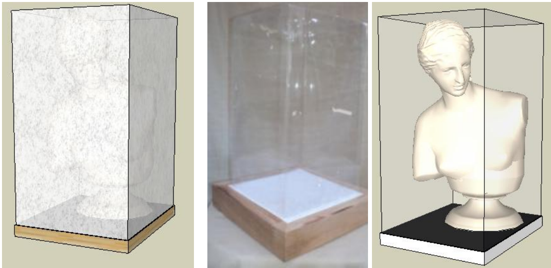
Fig. 38. Exemplos das combinações de materiais possíveis para a execução do modelo de acondicionamento: base de compensado naval ou placa de policarbonato, E.P.E. ou foamboard recobertos com Tyvek® ou algodão cru, e invólucro de entretela sem goma, folha de polietileno transparente ou placa de policarbonato. Modelos elaborados no software SketchUp Make ®.
