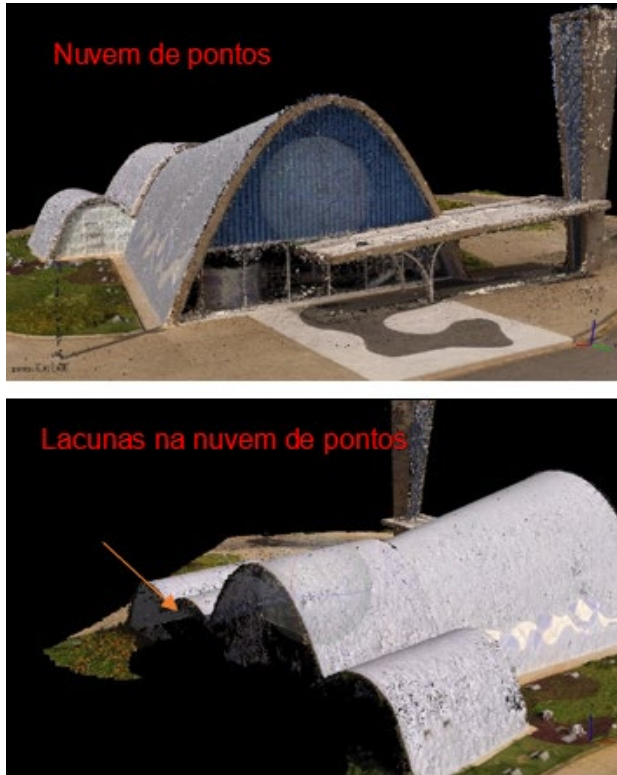
Figura 5 - Resultado da nuvem de pontos com a junção das imagens capturadas nos voos.
